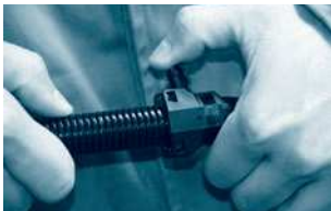
Schritt 4: Rastnasen nach außen schwenken (Demontage der Verschraubung).
