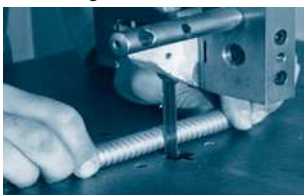
Schritt 1: Mit hoher Schnittgeschwindigkeit auf einer Bandsäge durchtrennen.
