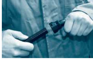
Schritt 2: Schlauch in „geschlossene“ Verschraubung bis zum festen Anschlag einstecken (Montage der Verschraubung).
