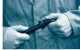
Schritt 3: Wellschlauch in Verschraubung leicht nach hinten ziehen (sichere Verrastung).
