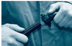
Schritt 5: Wellschlauch aus Verschraubung ziehen.
