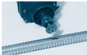
Schritt 2: Mit kleinem Hartmetallsägeblatt axial einschneiden.
